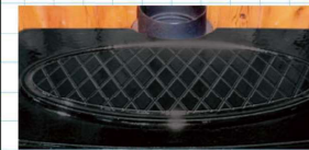
■ 天板(各種)クックトップ付 天板は鍋等の底板が均等の温度になるように、溝付きのクックトップになっております。これにより料理をするとき、一部だけが焦げてしまうことが解消されます。
